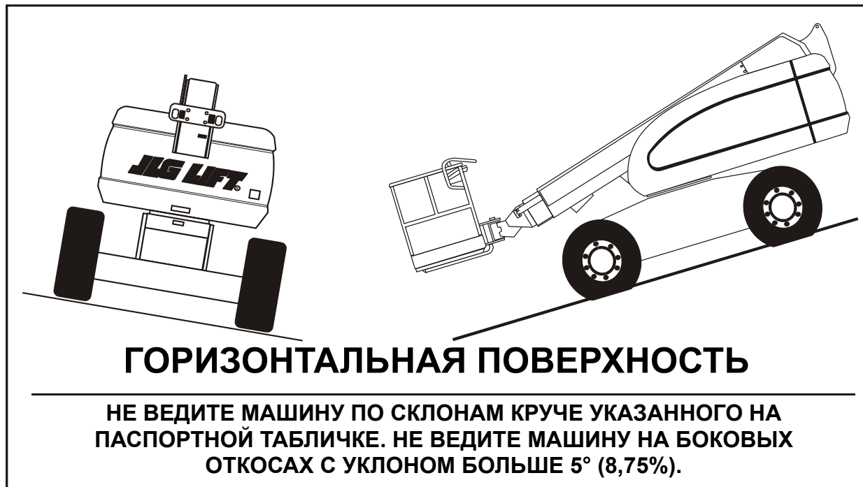
Рисунок 4-3. Уклон и боковой откос
