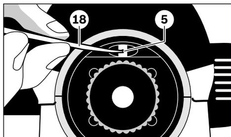
Откройте крышку окуляра **4**. С помощью стержня для настройки **18** поворачивайте юстировочный винт **5** по часовой стрелке/против часовой стрелки, пока при измерении на нивелирной рейке **B** не будет достигнуто рассчитанное значение высоты **b<sub>2</sub>**.
