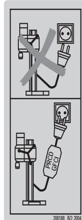
Использовать при работе неисправный автомат защиты от тока утечки запрещается.
