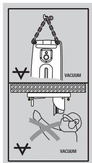
Сверху: горизонтальное сверление с вакуумным креплением разрешается выполнять только при использовании дополнительных устройств крепления станины сверлильного станка.
